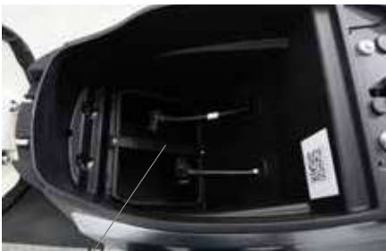
VANO BATTERIA CON BATTERIE ESTRATTE
