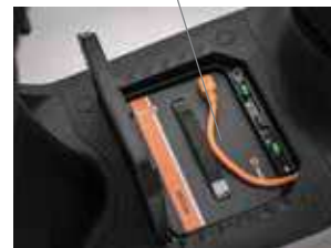
VANO BATTERIA APERTO
