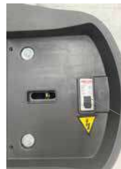
INTERRUTTORE GENERALE OFF
