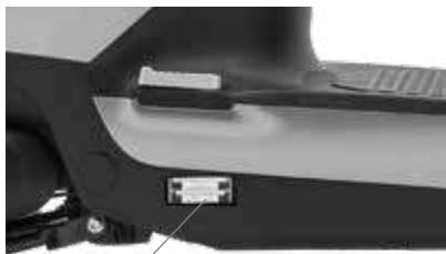
TARGHETTA DEL COSTRUTTORE FISSATA SUL TELAIO
