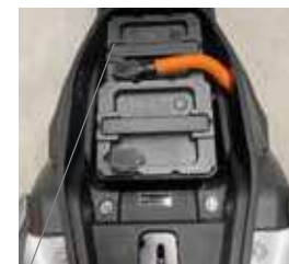
Sostituzione batteria carica aggiuntiva
