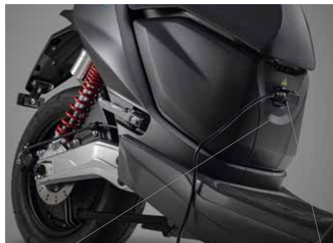
Ricarica batteria diretta sul veicolo
