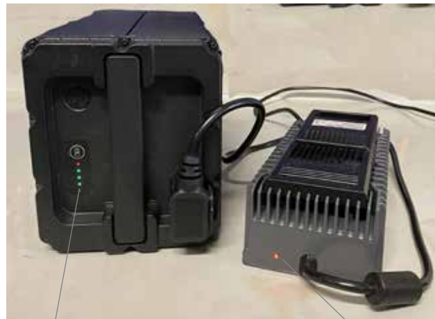
Fase di ricarica batteria
