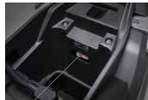
3. Interruttore generale su ON
