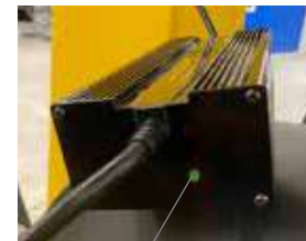
SPIA CARICABATTERIE VERDE AL TERMINE DELLA RICARICA
