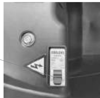
INTERRUTTORE GENERALE OFF
