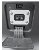
PRESA RICARICA ONBOARD APERTA (DOPO AVER PREMUTO SULL' APPOSITO SPORTELLINO DI CHIUSURA)
