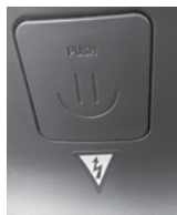
PRESA RICARICA ONBOARD CHIUSA
