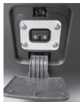
PRESA RICARICA ONBOARD APERTA
