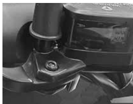
FINESTRA DI ISPEZIONE LIQUIDO FRENI
