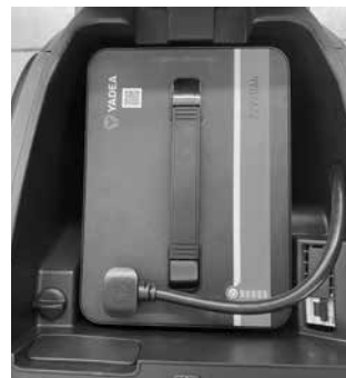
PRESA RICARICA ONBOARD APERTA (DOPO AVER PREMUTO SULL' APPOSITO SPORTELLINO DI CHIUSURA)
