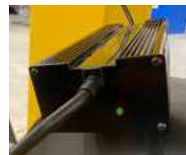
SPIA CARICABATTERIE VERDE AL TERMINE DELLA RICARICA
